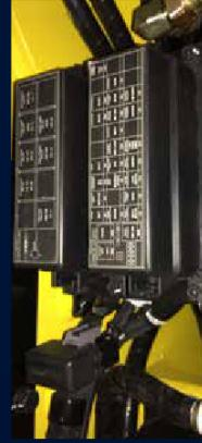
Todos los fusibles y relés están centralizados en tres cajas con una **protección mejorada a prueba de agua y polvo IP65**. Las cajas en sí se encuentran bajo el reposapiés para un **acceso rápido**.
