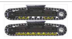
Protectores de las orugas: mejoran la protección, la alineación de las orugas y el rendimiento de la máquina en los desplazamientos. 3 protecciones por oruga de serie en la DX49oLC-7K y la DX53oLC-7K (protección en toda la longitud opcional) y 2 en la DX42oLC-7K (protecciones dobles o en toda la longitud disponibles como opción). Estas opciones de protección constituyen soluciones óptimas para aplicaciones extremas.
