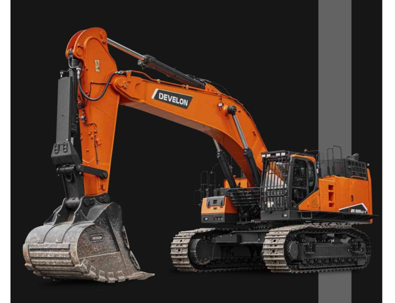
Potencia máxima 402 kW Peso operativo 79,5 t Capacidad de la cuchara 4,26 - 5,24 m³
